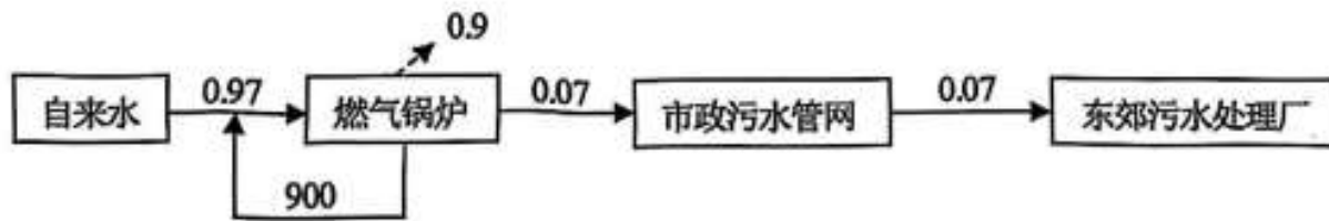
附图5 水平衡图 (单位: m 3 /d)
