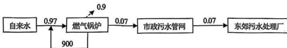
图1 本项目水平衡图 (单位: m^3/d )
